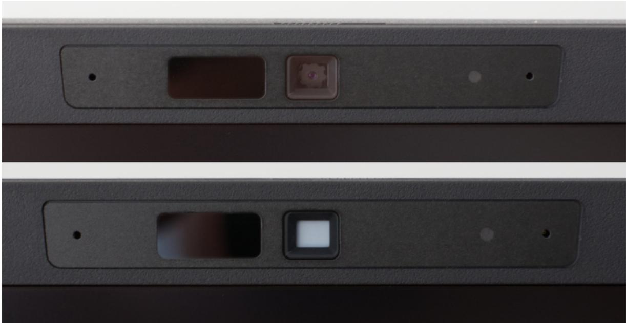
*Cámara web lista para funcionar en la parte superior, apagada en la parte inferior mediante una pantalla blanca de privacidad*
