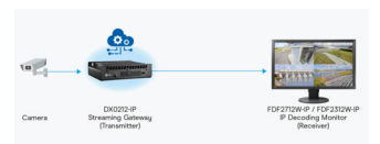
Caja IP y monitor IP
